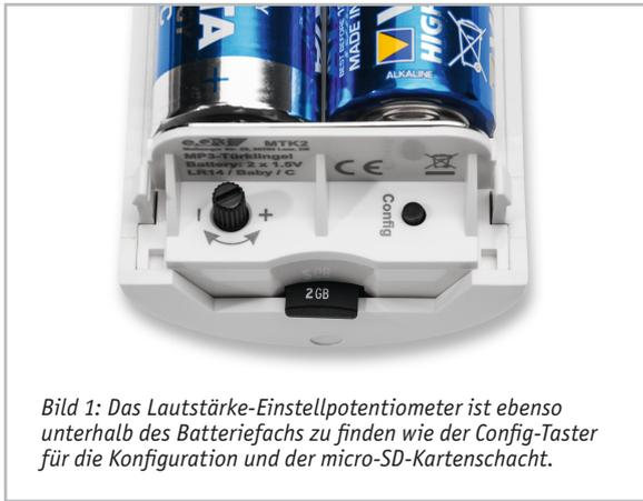
Bild 1: Das Lautstärke-Einstellpotentiometer ist ebenso unterhalb des Batteriefachs zu finden wie der Config-Taster für die Konfiguration und der micro-SD-Kartenschacht.
