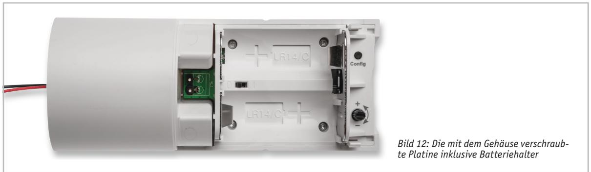
Bild 12: Die mit dem Gehäuse verschraubte Platine inklusive Batteriehalter
