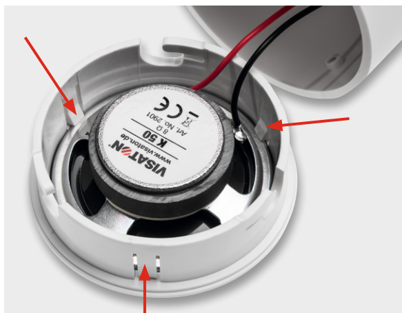
Bild 16: Die Rastnasen des Deckels werden von außen angedrückt.
