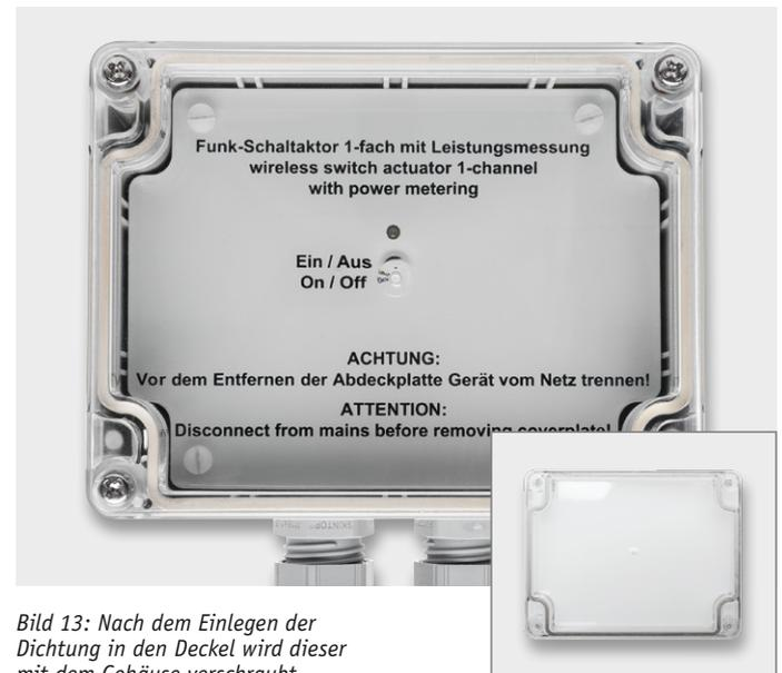
Bild 13: Nach dem Einlegen der Dichtung in den Deckel wird dieser mit dem Gehäuse verschraubt.
