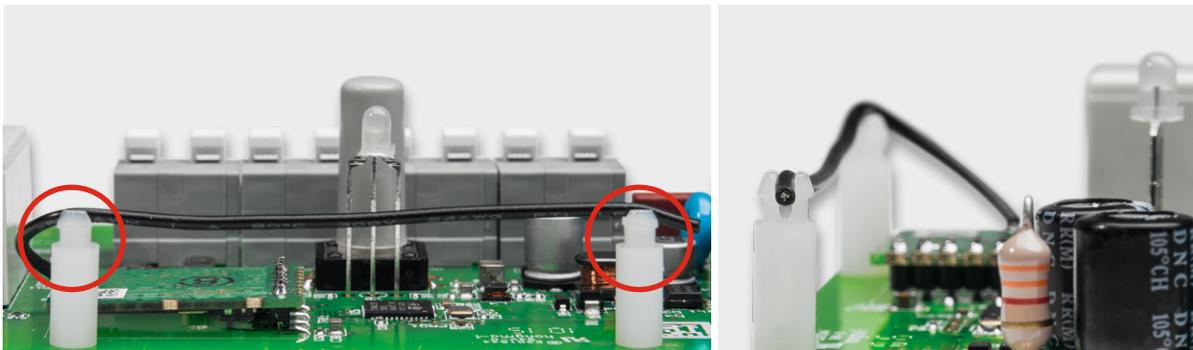
Bild 8: So ist die Antenne des TRX-Moduls zu verlegen und zu fixieren.
