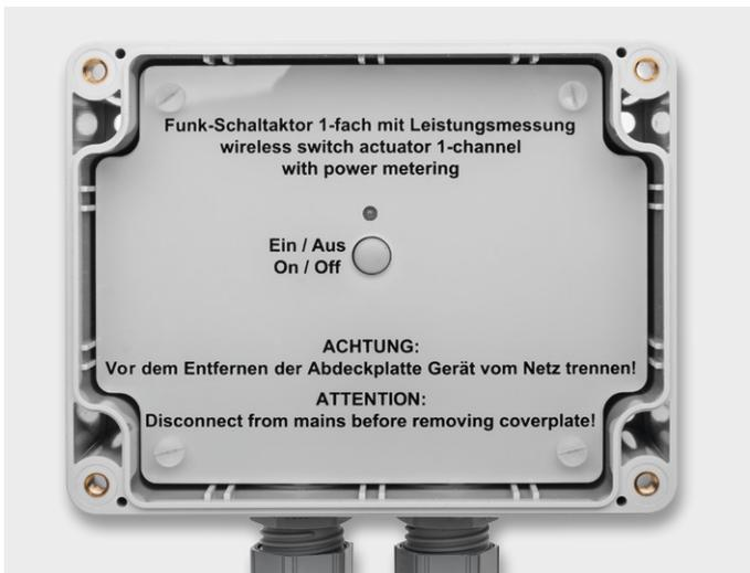
Bild 12: Die Abdeckplatte wird mit vier Kunststoffschrauben fixiert
