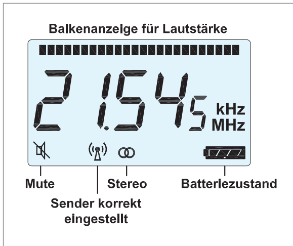
Bild 7: Das LC-Display des WE1 zeigt alle notwendigen Informationen an.
