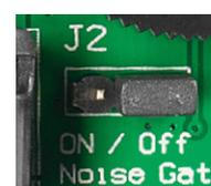
Bild 3: Der Jumper für das Noise-Gate
