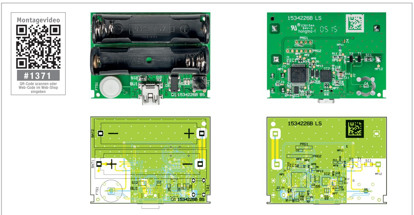
Bild 2: Die Platinenfotos der komplett bestückten TFD-500-Platine mit zugehörigen Bestückungsplänen (links Oberseite, rechts Unterseite)
