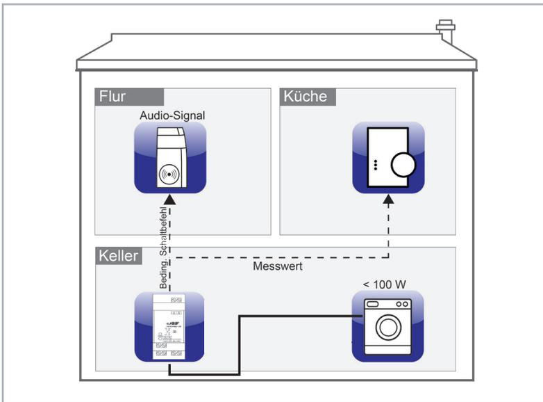
Bild 1: Ein Beispiel für das bedingte Schalten
