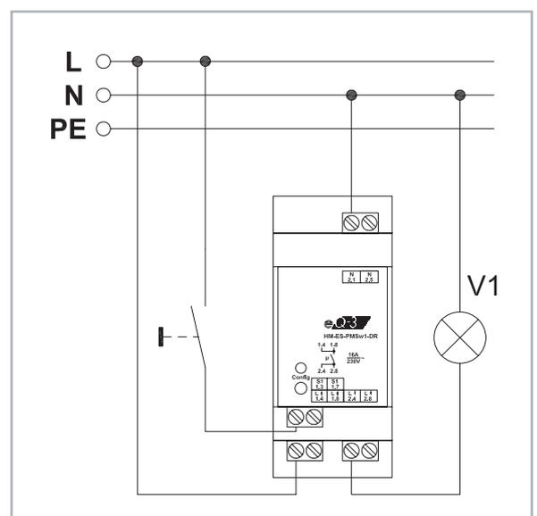
Bild 15: So erfolgt der elektrische Anschluss des Geräts.
