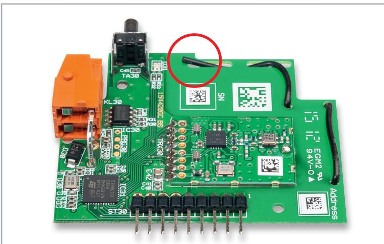
Bild 7: Hier ist die Verlegung der Transceiver-Antenne auf der Platinenoberseite ...
