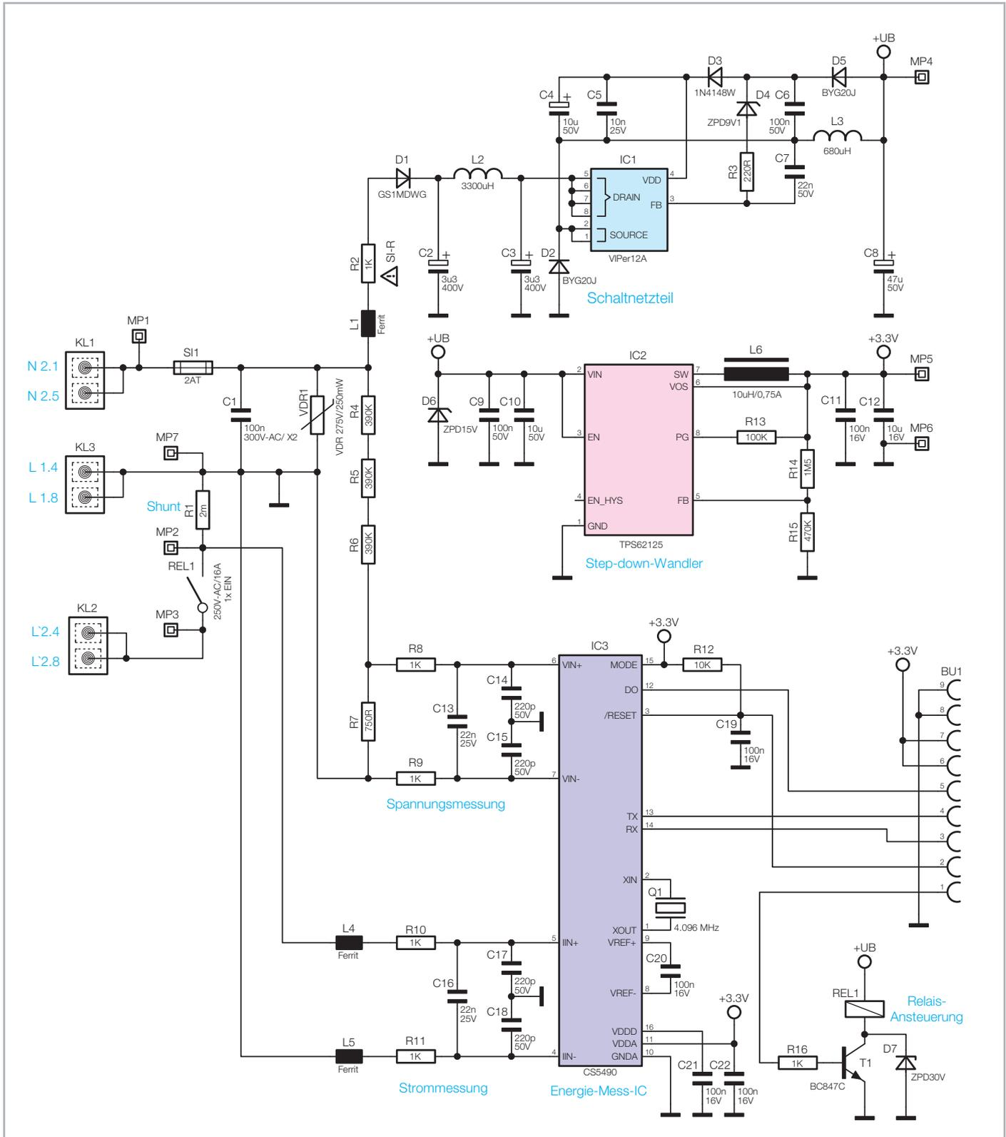
Bild 2: Das Schaltbild der Netzteilplatine mit Spannungsversorgung und Energie-Mess-IC
