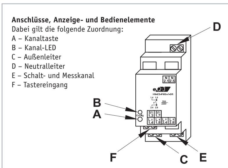
Bild 14: Die Lage von Anschlüssen, Anzeige- und Bedienelementen
