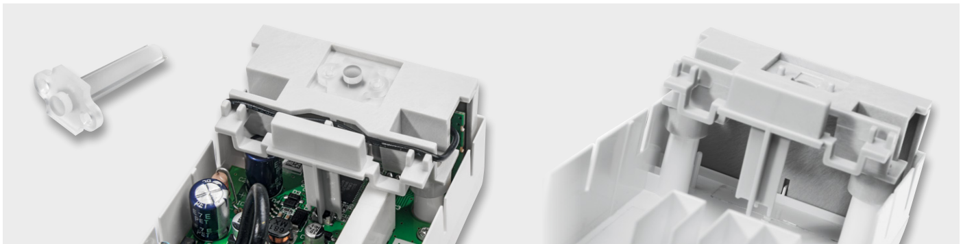
Bild 5: Der Lichtleiter ist in die Tasterkappe einzukleben bzw. einzuschmelzen (siehe Text). Rechts ist die Lage der Tasterkappe im Gehäuse zu sehen.
