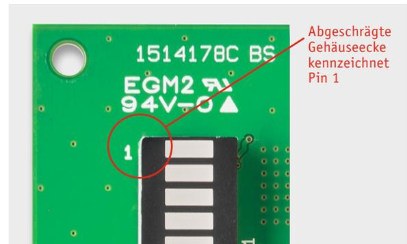
Bild 5: Die Kennzeichnung von Pin 1 an den LED-Displays
