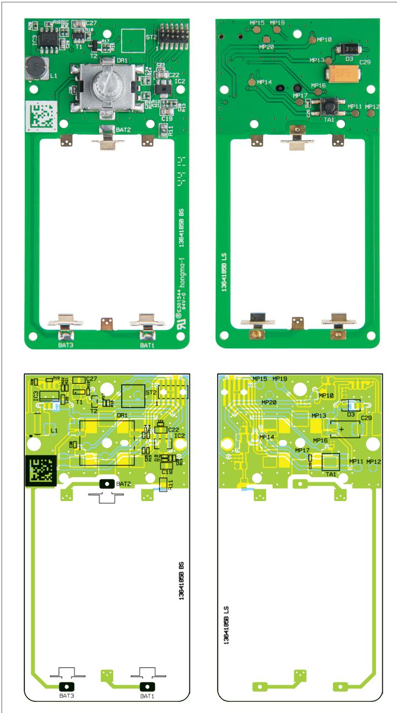
Bild 2b: Platinfoto der bestückten Encoderplatine mit zugehörigem Bestückungsplan
