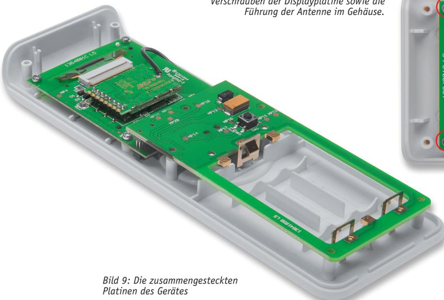
*Bild 9: Die zusammengesteckten Platinen des Gerätes*
