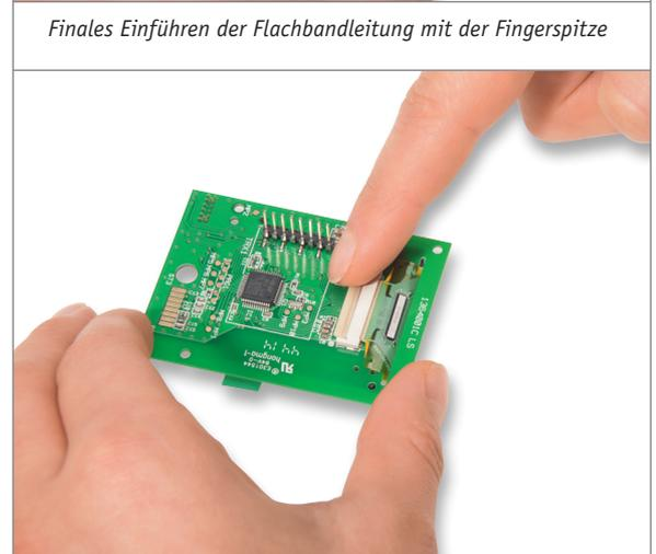
Fixieren des Verbinders durch das Herunterdrücken des Hebels
