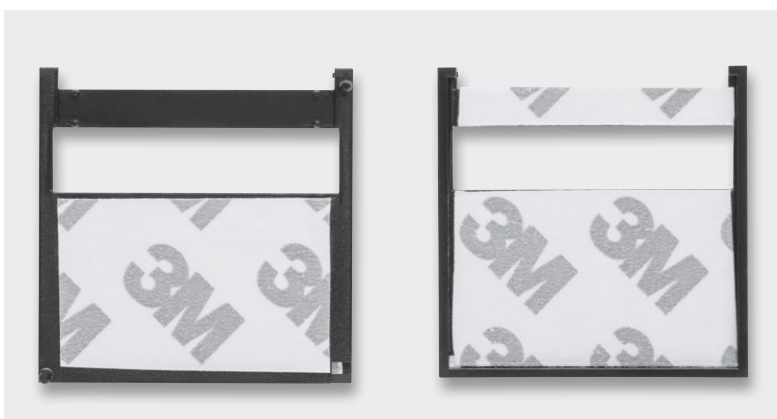
Bild 3: Das Aufkleben des doppelseitigen Klebebandes auf den Displayrahmen, links die Unterseite, rechts die Oberseite
