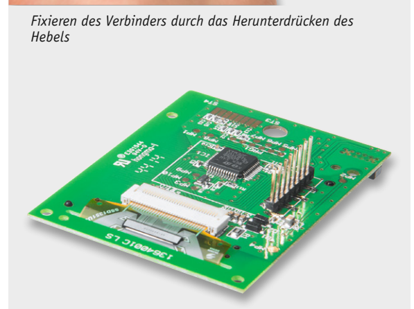
Bild 4: So erfolgt das Einfädeln, Einlegen und Fixieren der Display-Flachbandleitung in den Steckverbinder. Ganz unten der so fertiggestellte Anschluss.
