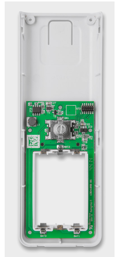
Bild 6: Die Lage der Batteriekontakte auf der Encoderplatine
