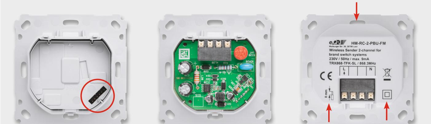
Bild 10: Die Isolierplatte zwischen Controller- und Netzteilplatine ist eingelegt. Rechts unten ist die Steckerleiste für die Verbindung beider Platinen zu sehen.
