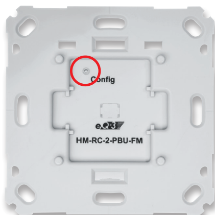
Bild 13: Der Tasterstößel ist auf Leichtgängigkeit zu prüfen.
