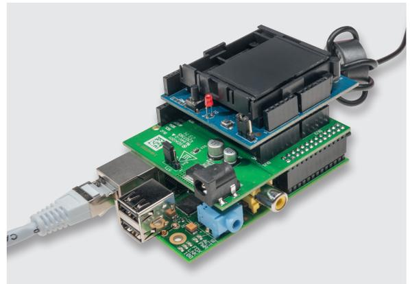
Bild 8: Hier ist der Einsatz der I<sup>2</sup>C-Flip-Anzeige (Best.-Nr. J6-10 48 63) zu sehen.
