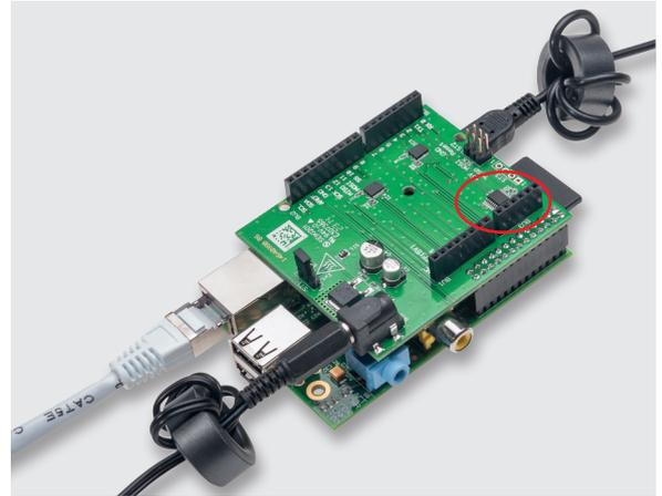
Bild 6: Das Einlesen von Analogwerten erfolgt über den auf dem RPi-AA1 integrierten A/D-Wandler und die Kontakte der BU3.
