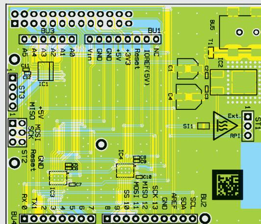
Bild 2: Das vollständig bestückte Adapterboard mit dem zugehörigen Bestückungsplan
