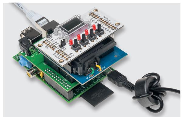
Bild 9: Auch für das I<sup>2</sup>C-LCD-Modul werden diverse Anwendungsbeispiele bereitgestellt (Best.-Nr. J6-09 92 53).
