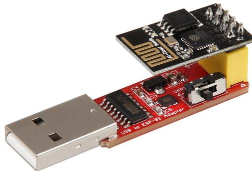
Neben dem gelben Connector befinden sich ein kleiner Schalter (ebenfalls auf dem Bild zu erkennen). Achten Sie darauf, dass dieser auf **Prog** gestellt ist, wenn Sie Ihren ESP8266 programmieren möchten. Für eine reguläre Verwendung des Moduls, stellen Sie das Programmiermodul auf **UART**.
