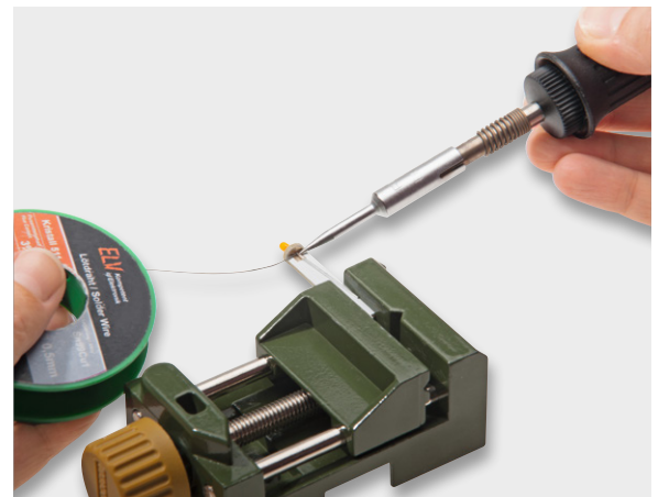
Bild 6: Ein nützlicher Helfer ist ein kleiner Schraubstock, mit dem die Platinen fixiert werden können.
