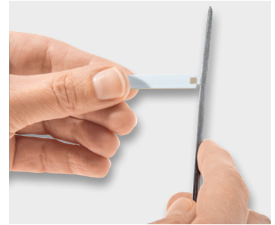
Bild 3: Nach dem Herausbrechen der Platinen wird der Grat mit einer Feile entfernt.
