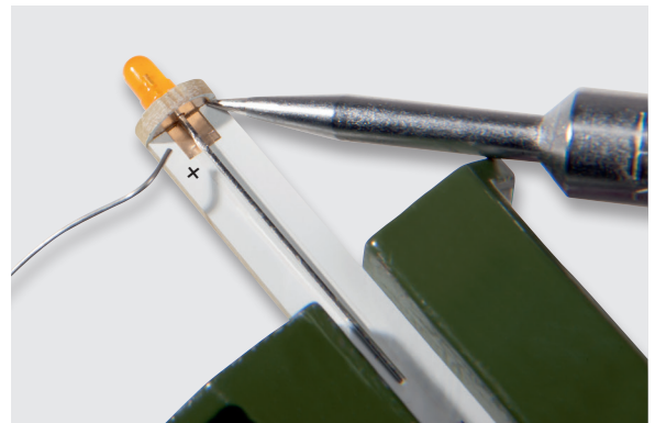
Bild 7: Der längere Anschluss der LED wird auf der mit „+“ markierten Seite angelötet.
