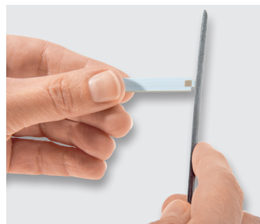
Bild 3: Nach dem Herausbrechen der Platinen wird der Grat mit einer Feile entfernt.
