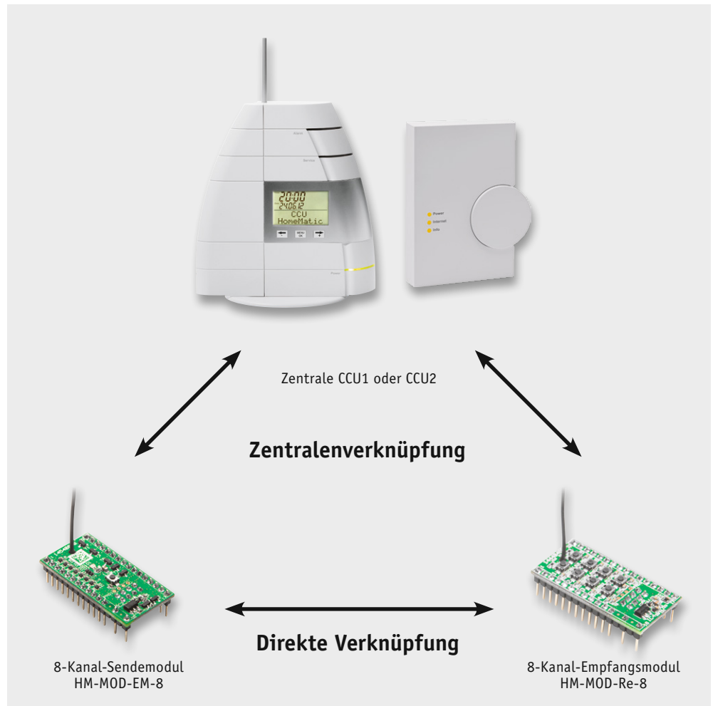
Bild 4: Unterschied zwischen direkter Verknüpfung und Zentralenverknüpfung
