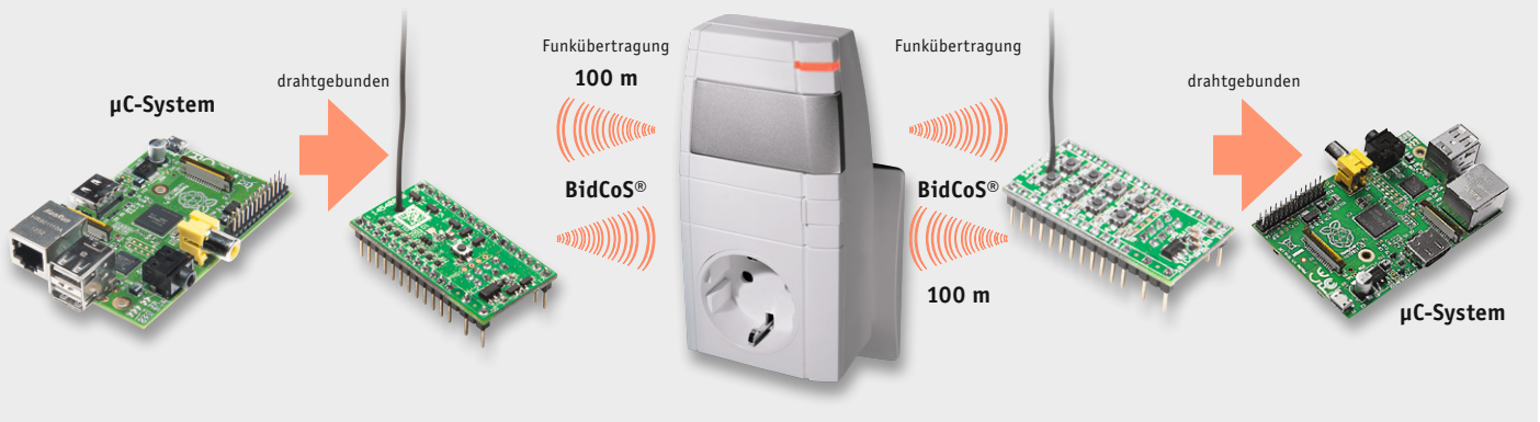
Bild 2: Zur Reichweitenverlängerung des Sender-Empfänger-Pärchens hält das HomeMatic-System einen Repeater bereit.
