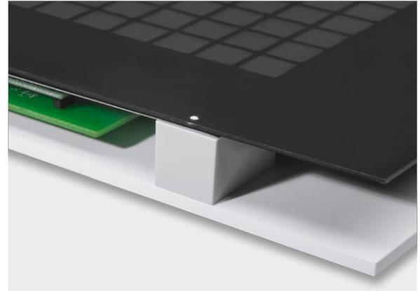
Bild 14: Die mittels der Zentriernasen in der Lichtmaske positionierten Folien (Diffusor/Farbfilter) und die Frontblende
