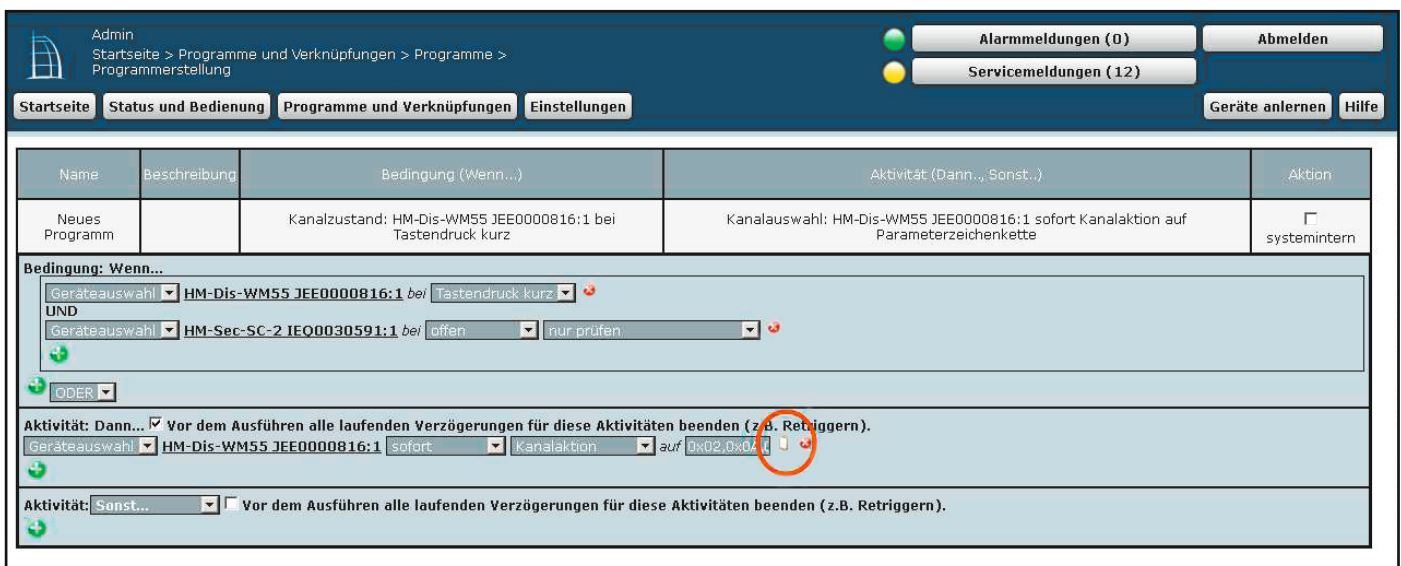
Bild 24: Die Verknüpfungen von Ereignissen, Skripten, Aktionen und entsprechenden Anzeigen sowie die Reaktionen auf die Bedienung eines Tasters am Anzeigergerät erfolgen über die WebUI der HomeMatic-Zentrale.
