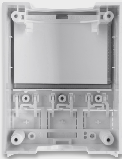
Bild 6: Auf das Display ist die Diffusor-Folie zu legen.
