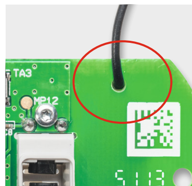
Bild 6: Hier ist die Antenne des Transceivermoduls hindurchzuführen.
