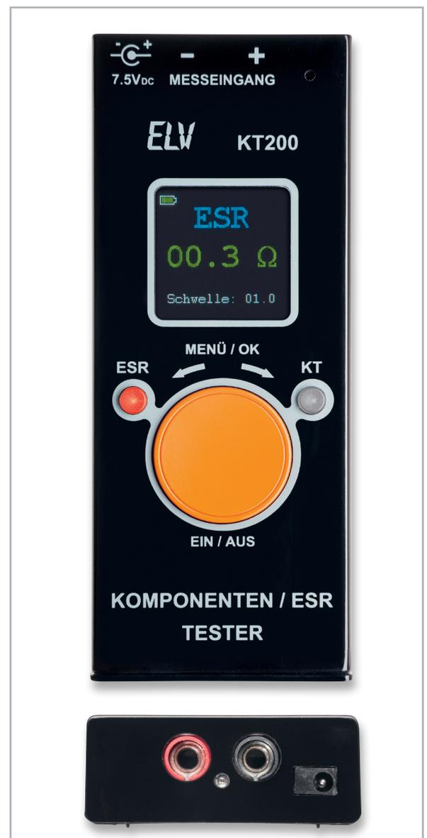
Bild 13: Frontansicht mit den aufgesetzten Bedienelementen, man sieht die in der Taste liegende LED für die ESR-Funktion leuchten. Darunter die Sicht auf die Mess- und Stromversorgungsbuchsen.
