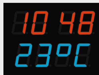
Bild 4: Der Einsatz von unterschiedlichen FarbfILTERfolien individualisiert die Anzeige und grenzt Anzeigearten voneinander ab.
