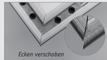
Bild 21: Beim Zusammensetzen der Seitenteile kommt es auf Fingerspitzengefühl an, damit die Profile richtig zusammenpassen.
