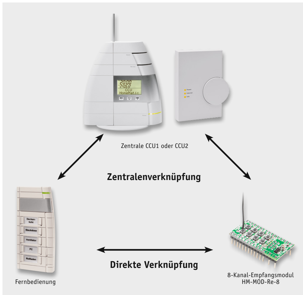
Bild 2: Unterschied zwischen direkter Verknüpfung und Zentralenverknüpfung
