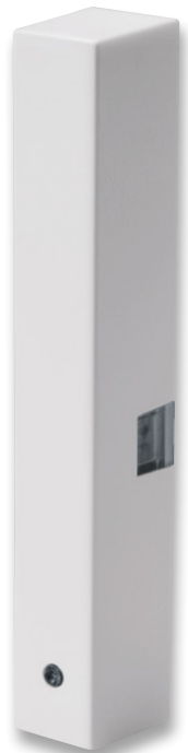
Bild 7: Der fertig aufgebaute Tür-/Fensterkontakt
