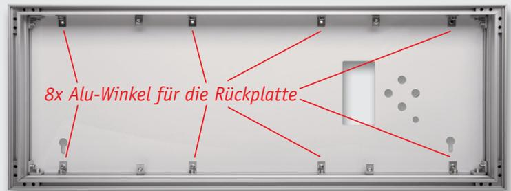
Bild 16: Der Gehäuserahmen, hier zur Übersicht bereits im montierten Zustand
