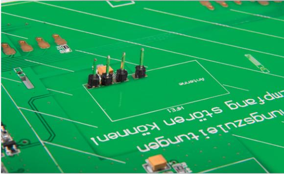
Bild 11: Die Stiftleiste für das Auflöten des Funkmoduls
