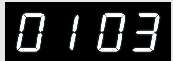
Bild 2: Die lückenlos zusammengesetzten Anzeigen für die Zähler-Darstellung
