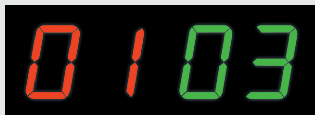
Bild 3: Ideal für die Spielstandsanzeige: die Bestückung mit unterschiedlichen Farbfolien
