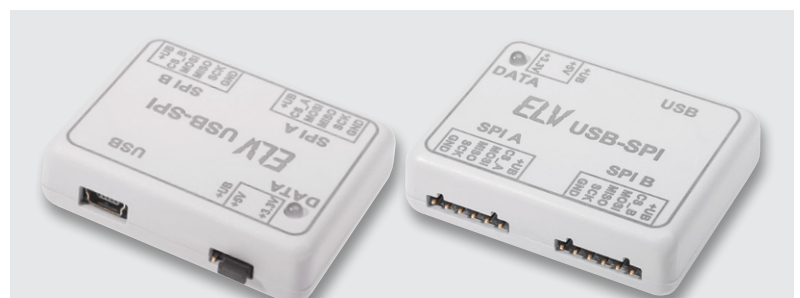
Bild 4: Das fertig montierte Gerät. Rechts sind deutlich die Aussparungen für die vorkonfektionierten Stecker zu sehen, die ein polrichtiges Stecken erzwingen.
