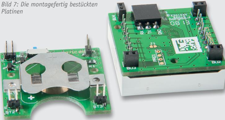
Nun sind Controller- und Powerplatine (Bild 7) zusammenzustecken (Bild 8) und die Knopfzelle ist polrichtig (Plus nach außen) einzusetzen.
