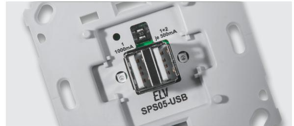
Bild 2: DIP-Schalter zur Ausgangskonfiguration
