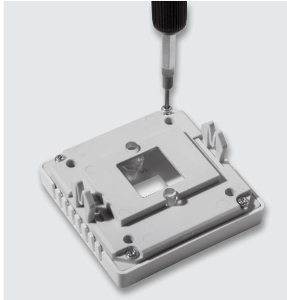
Bild 28: Verschrauben der Gehäusehälften der Frontabdeckung
