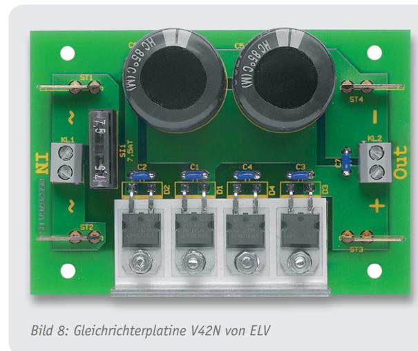
Bild 8: Gleichrichterplatine V42N von ELV
