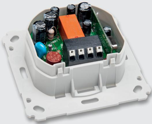
Bild 23: Einsetzen der Netzteilplatine auf die Isolierplatte
