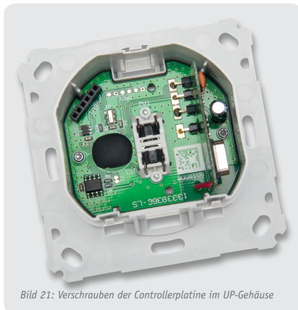
Bild 21: Verschrauben der Controllerplatine im UP-Gehäuse
