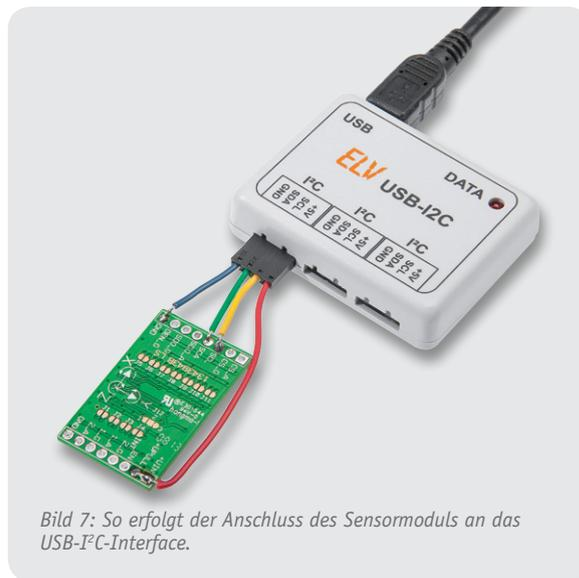
Bild 7: So erfolgt der Anschluss des Sensormoduls an das USB-I<sup>2</sup>C-Interface.
