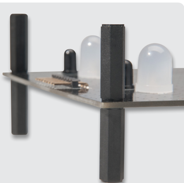
Bild 4: Montage der Abstandshalter zur Einstellung eines optimalen Abstands zur Abdeckfläche
