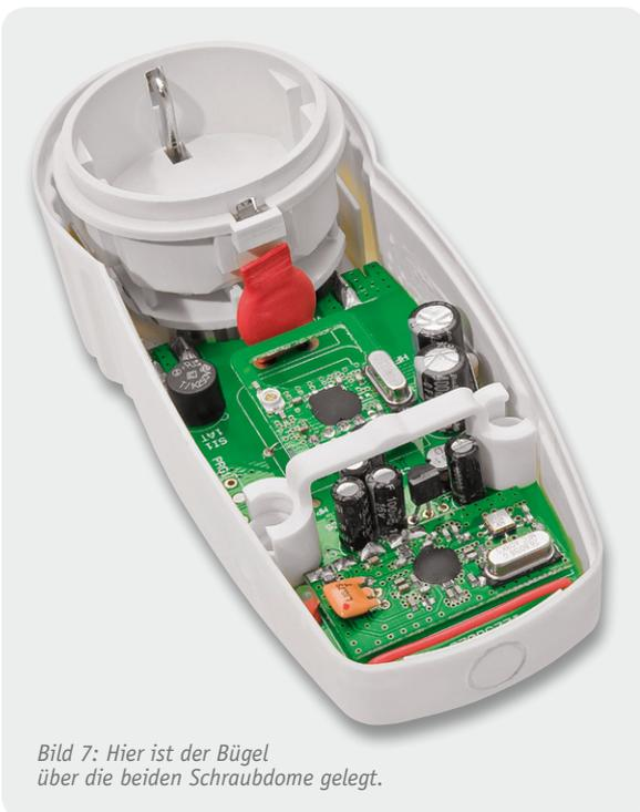
Bild 7: Hier ist der Bügel über die beiden Schraubdomen gelegt.
