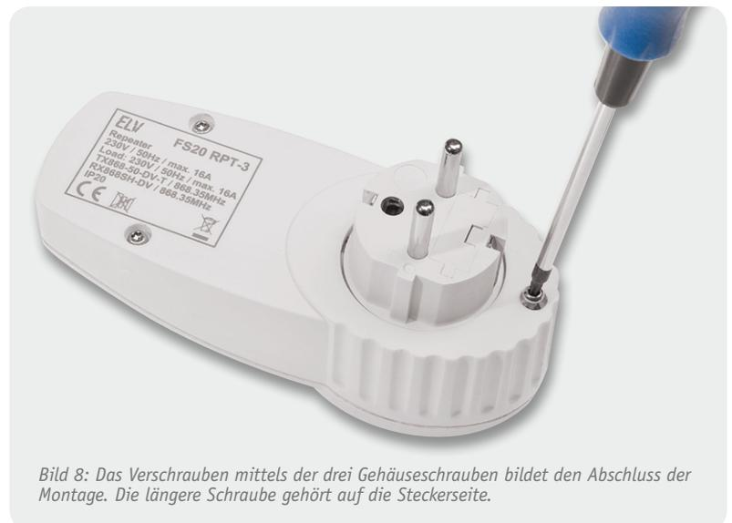
Bild 8: Das Verschrauben mittels der drei Gehäuseschrauben bildet den Abschluss der Montage. Die längere Schraube gehört auf die Steckerseite.
