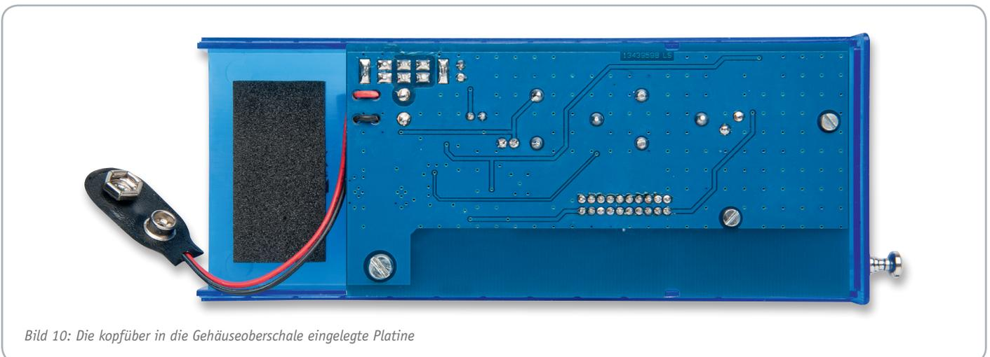
Bild 10: Die kopfüber in die Gehäuseoberschale eingelegte Platine
