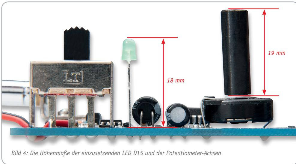
Bild 4: Die Höhenmaße der einzusetzenden LED D15 und der Potentiometer-Achsen
