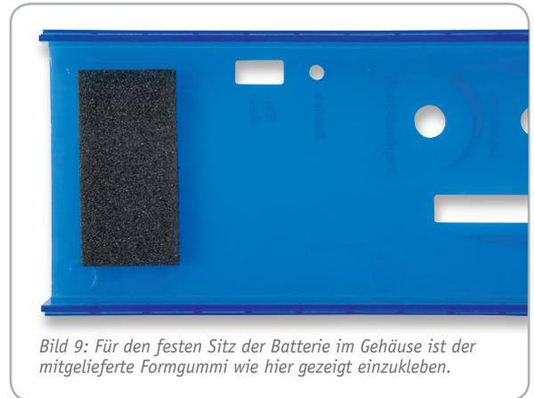
Bild 9: Für den festen Sitz der Batterie im Gehäuse ist der mitgelieferte Formgummi wie hier gezeigt einzukleben.
