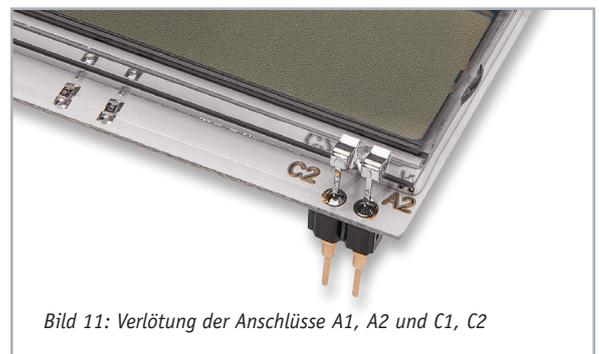
Bild 11: Verlöten der Anschlüsse A1, A2 und C1, C2
