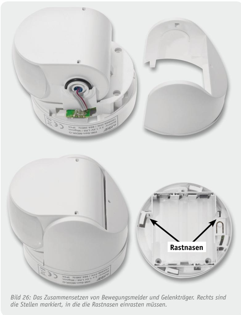
Bild 26: Das Zusammensetzen von Bewegungsmelder und Gelenkträger. Rechts sind die Stellen markiert, in die die Rastnasen einrasten müssen.
