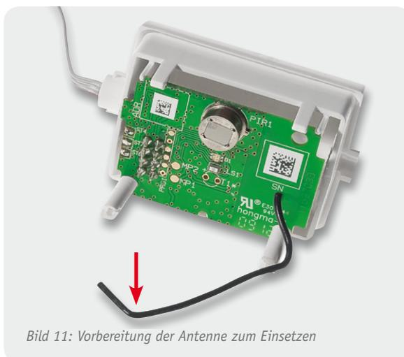
Bild 11: Vorbereitung der Antenne zum Einsetzen
