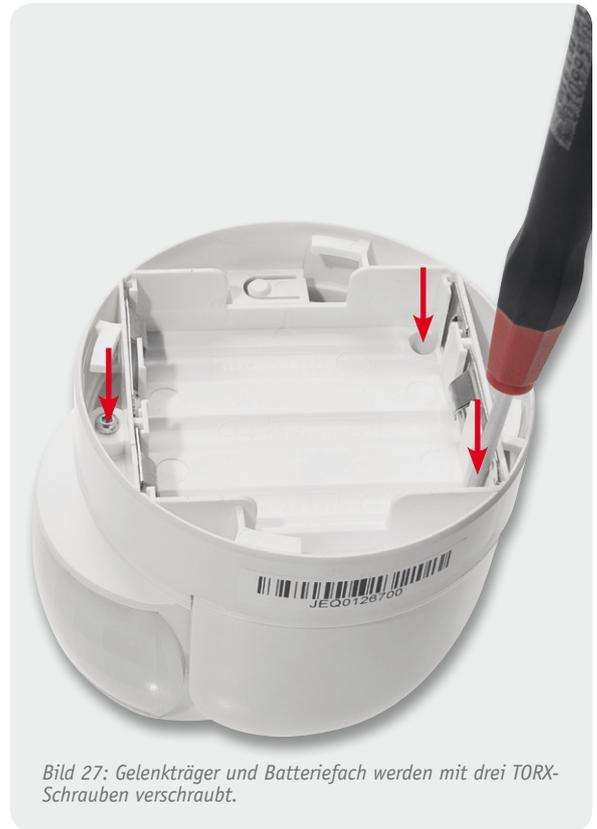
Bild 27: Gelenkträger und Batteriefach werden mit drei TORX-Schrauben verschraubt.
