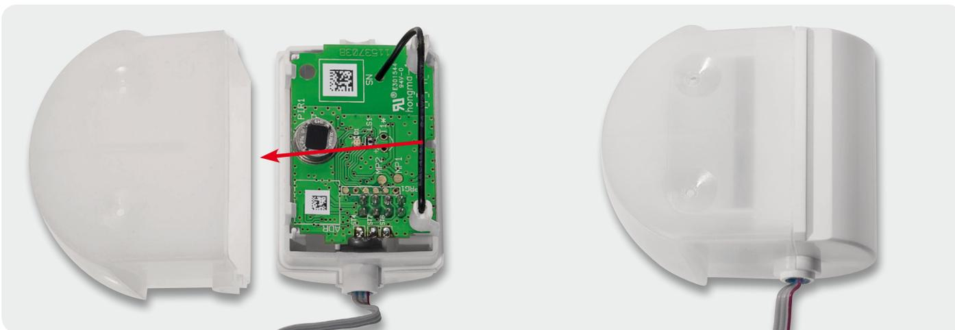
Bild 15: Das Zusammensetzen von hinterer Abdeckkappe und PIR-Linse
