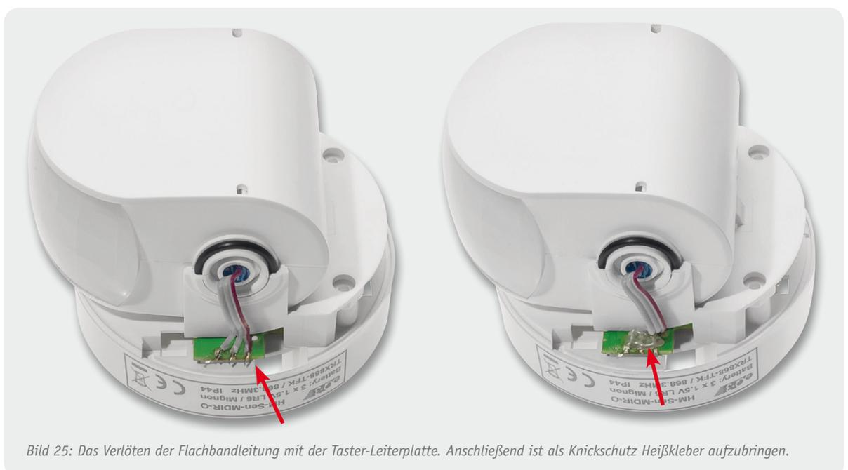
Bild 25: Das Verlöten der Flachbandleitung mit der Taster-Leiterplatte. Anschließend ist als Knickschutz Heißkleber aufzubringen.
