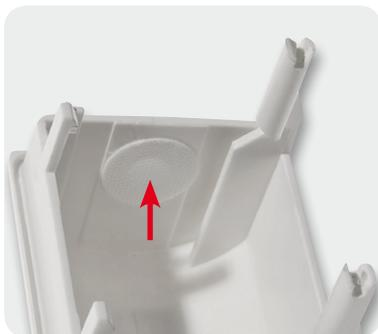
Bild 8: Hier ist die selbstklebende Membran einzusetzen.
