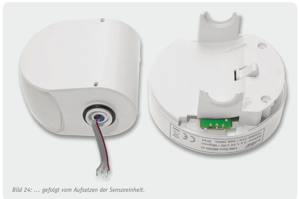
Bild 24: ... gefolgt vom Aufsetzen der Sensoreinheit.
