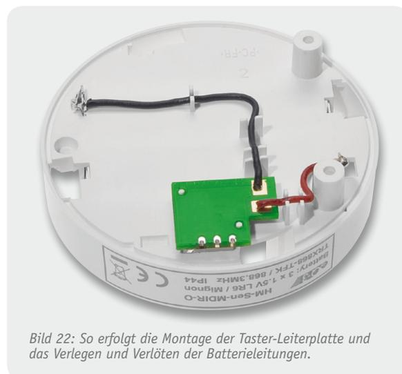
Bild 22: So erfolgt die Montage der Taster-Leiterplatte und das Verlegen und Verlöten der Batterieleitungen.
