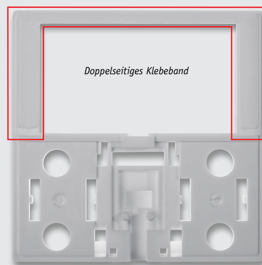
Bild 15: Das Anbringen des doppelseitigen Klebebands für die Displayfrontscheibe
