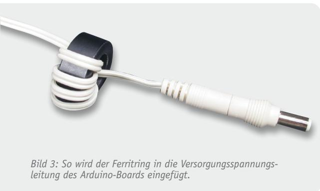
Bild 3: So wird der Ferritring in die Versorgungsspannungszuleitung des Arduino-Boards eingefügt.
