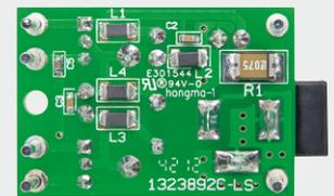
Bild 11: Fertig aufgebautes Modul (Platinenunterseite)
