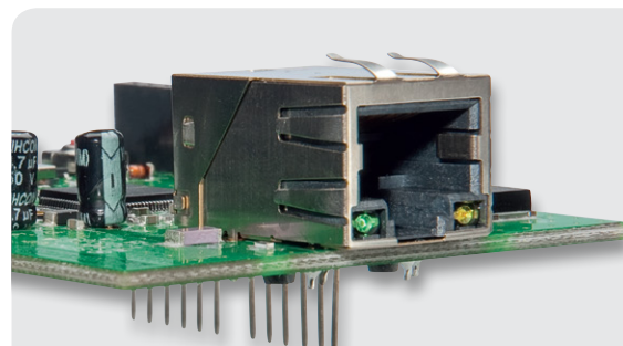
Bild 5: So ist die Ethernet-Buchse einzusetzen und zu verlöten.
