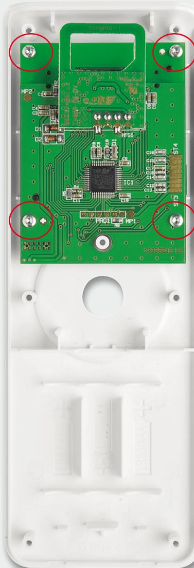
Bild 11: Die Displayplatine wird mit vier TORX-Schrauben im Gehäuseoberteil verschraubt.
