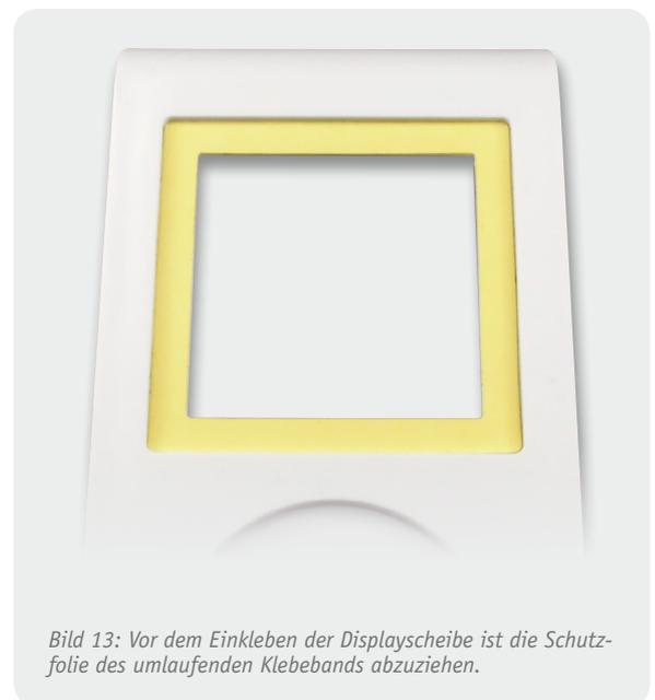
Bild 13: Vor dem Einkleben der Displayscheibe ist die Schutzfolie des umlaufenden Klebebands abzugeben.
