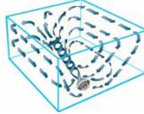
Der Luftaustritt durch das spiralförmige Schutzgitter lässt schließlich einen dicht verwirbelten und rotierenden Luftstrahl entstehen, der eine Reichweite von bis zu 30 m (je nach Modell) erzielt.
