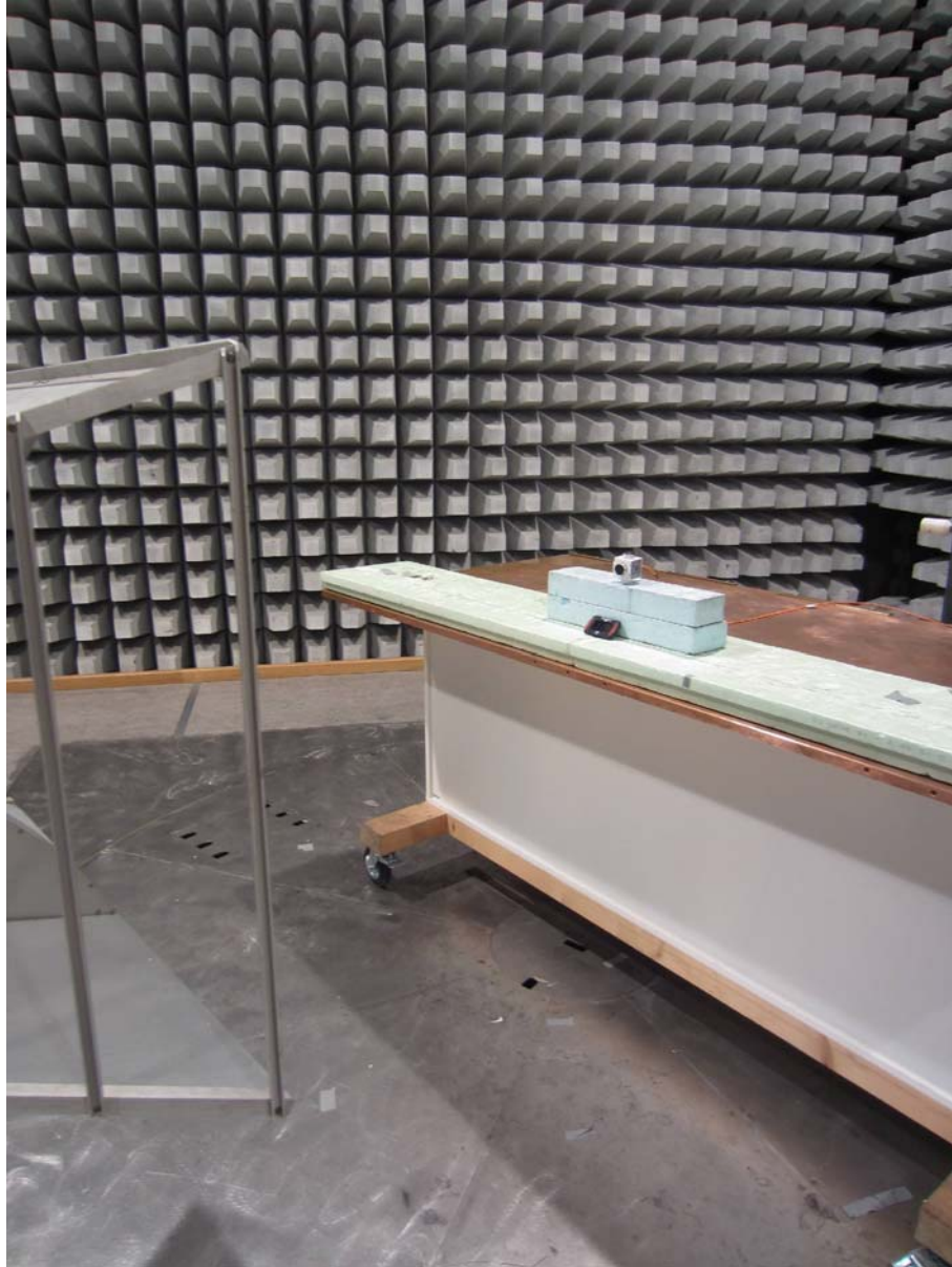
Messaufbau in der Messzelle / Test setup in the anechoic chamber (200 – 1000 MHz)
