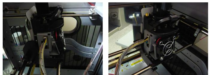
◆ Richten Sie das Lasergravurmodul an der Halterung aus und drücken Sie es zur Befestigung des Halters.
