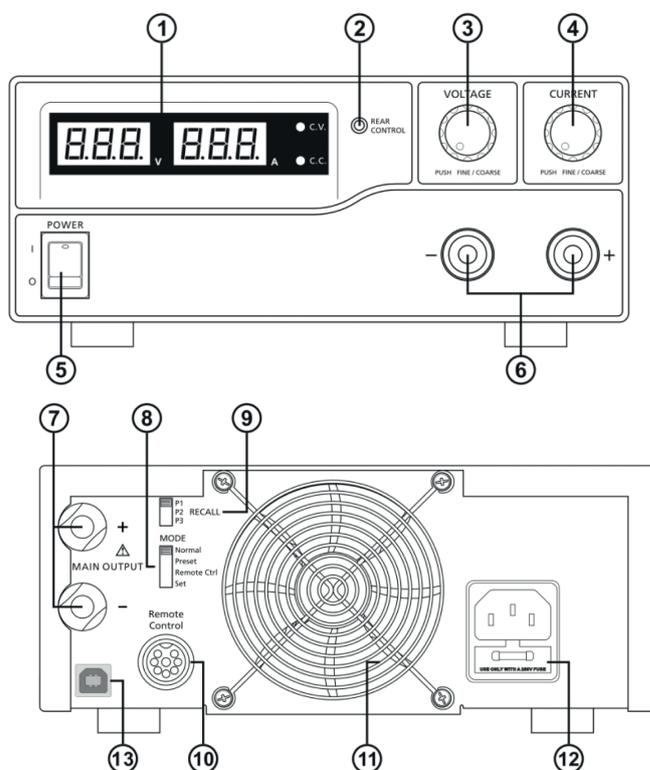
1. Display mit Anzeige für Konstantspannungs- (CV)/Konstantstrombetrieb (CC)
