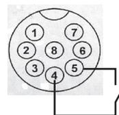
Kontaktbelegung von hinten auf die Lötkontakte gesehen.
