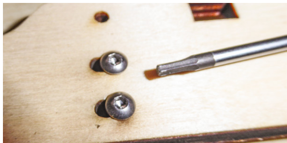
Bild 8: Eine Gewähr für stabile Verbindungen – Innensechskant-Schrauben und der mitgelieferte Schraubendreher
