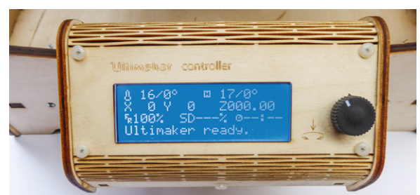
Bild 6: Der ebenfalls in einem Holzgehäuse untergebrachte Controller ermöglicht das autonome Arbeiten ohne angeschlossenen Computer.
